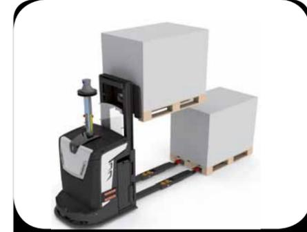
Zone tampon des palettes en pile (« load-on-load »)
