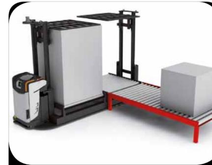
Chargement/déchargement sur convoyeur
